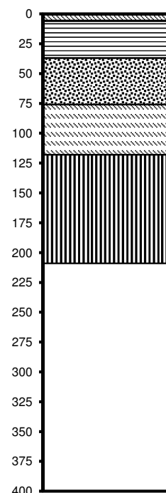
grafische laagopbouw asfaltconstructie
